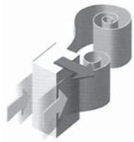
Figura 8 - Representação da amplitude dos vórtices (setas claras e paralelas) e do sentido de deflexão da barra trapezoidal (seta escura).
